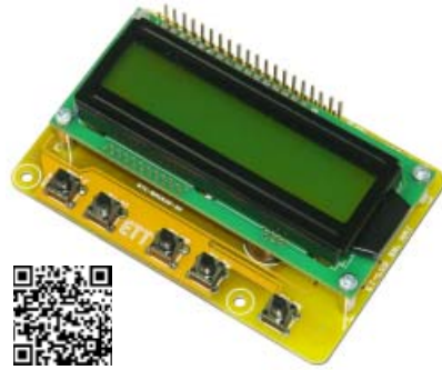
รูปการเชื่อมต่อบอร์ด ET-LCD SW HAT เข้ากับบอร์ด RASPBERRY PI
