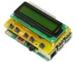
รูปการเชื่อมต่อบอร์ด ET-LCD SW HAT เข้ากับบอร์ด RASPBERRY PI
