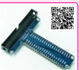
การต่อ PI-CONV 40T เข้ากับบอร์ด Raspberry PI2 MODEL B และ PROJECT BOARD
